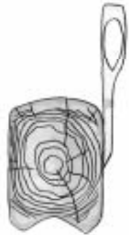
Modell 1900 Gewöhnlicher Scherenanschliff für Kantarbeit am Holz entlang "Kantbeil"
