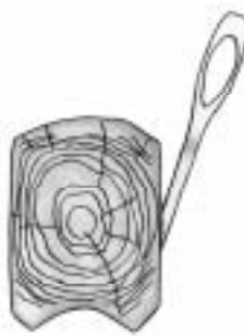
Modell 1900 Umgekehrter Scheren- anschliff. Zum Bebeilen von gezimmerten Wänden. Macht die Ecken leichter zugänglich und ergibt ein Wellenmuster "Beil zum Behauen"
