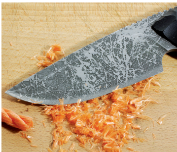
Schneidfriede: Die ballig geschliffene Klinge unseres Testmessers machte mit dem Nylonseil kurzen Prozess.
